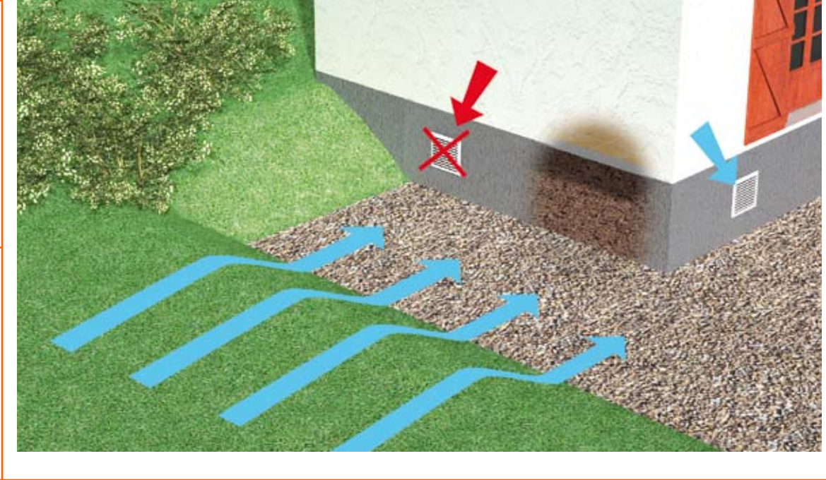
Disposition des grilles de ventilation du vide sanitaire par rapport au sens du courant
